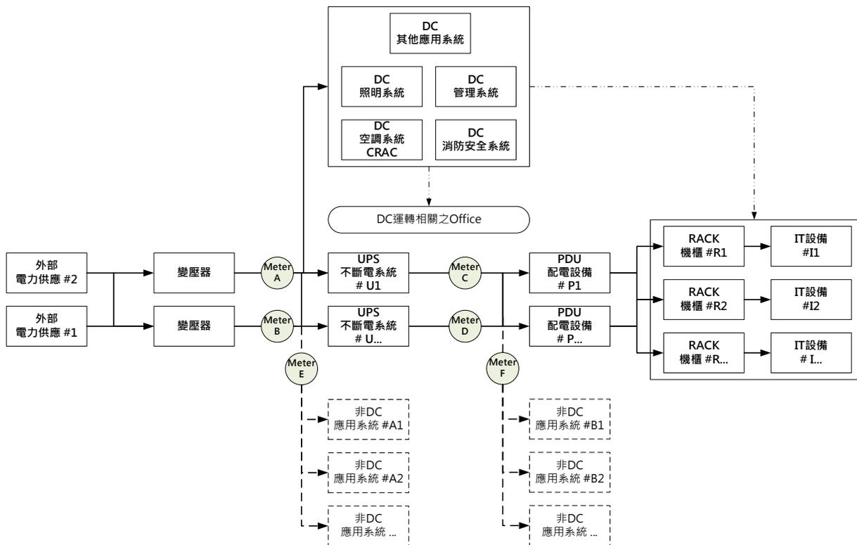
圖 13. 資料中心樣態 5 架構圖與  $PUE_{TaiSEIA}$  量測位置
