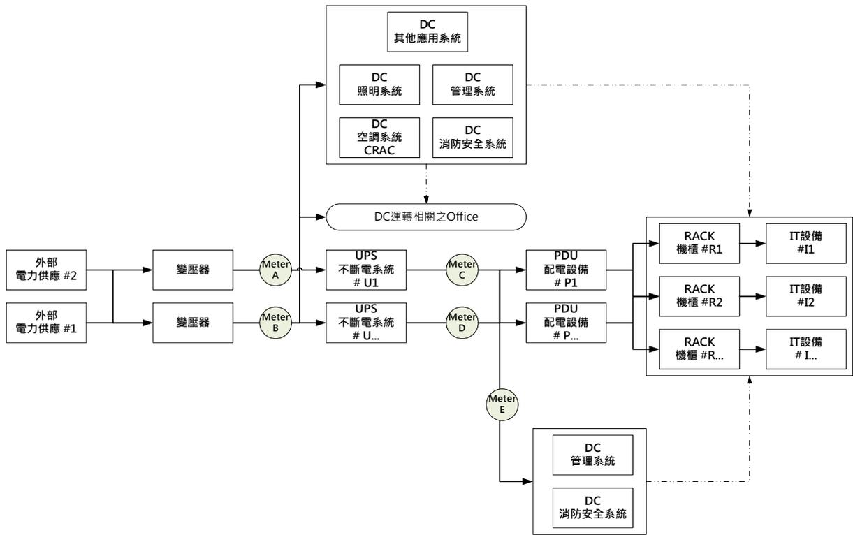
圖 11. 資料中心樣態 3 架構圖與 $PUE_{TaiSEIA}$ 量測位置
