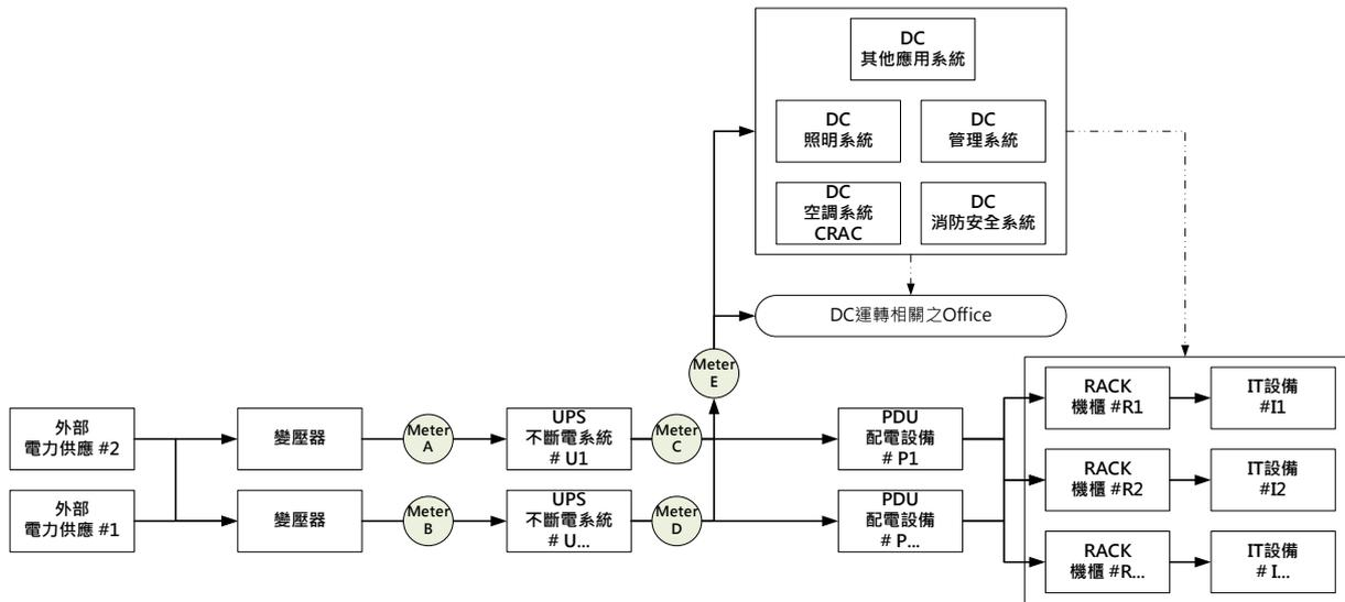
圖 10. 資料中心樣態 2 架構圖與 $PUE_{TaiSEIA}$ 量測位置
