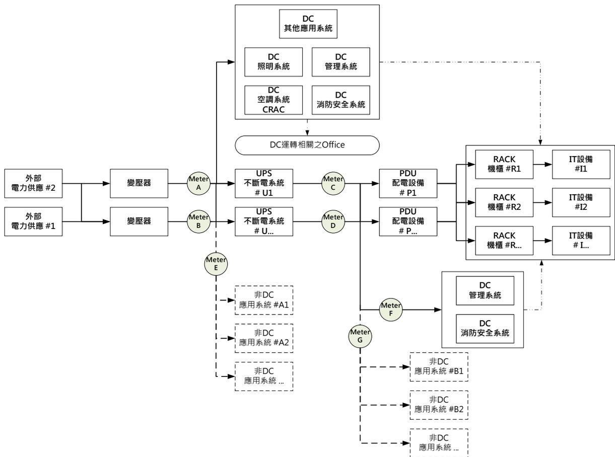
圖 15. 資料中心樣態 7 架構圖與 $PUE_{TaiSEIA}$ 量測位置
