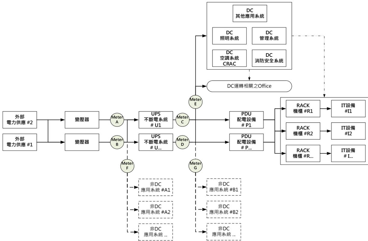
圖 14. 資料中心樣態 6 架構圖與 $PUE_{TaiSEIA}$ 量測位置
