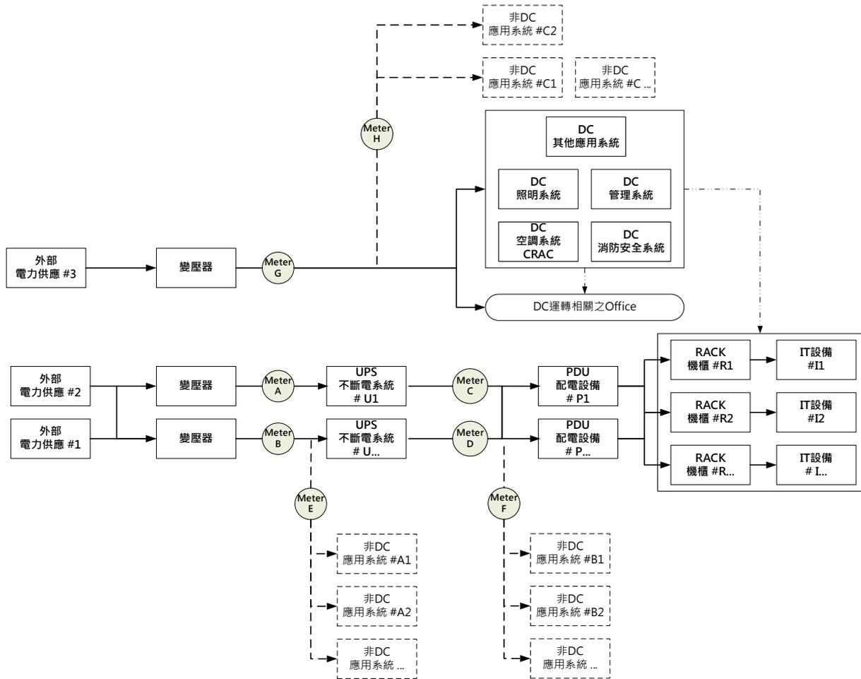
圖 18. 資料中心樣態 10 架構圖與 PUE<sub>TaiSEIA</sub> 量測位置
