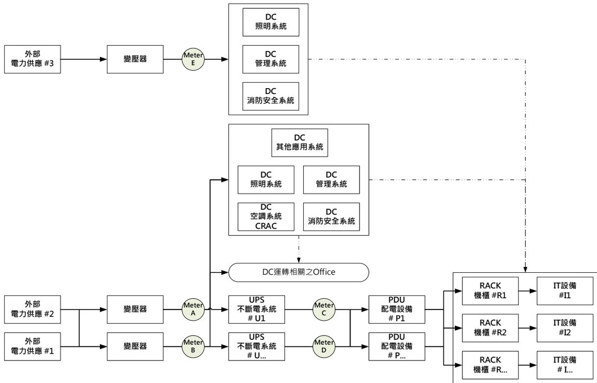
圖 12. 資料中心樣態 4 架構圖與  $PUE_{TaiSEIA}$  量測位置
