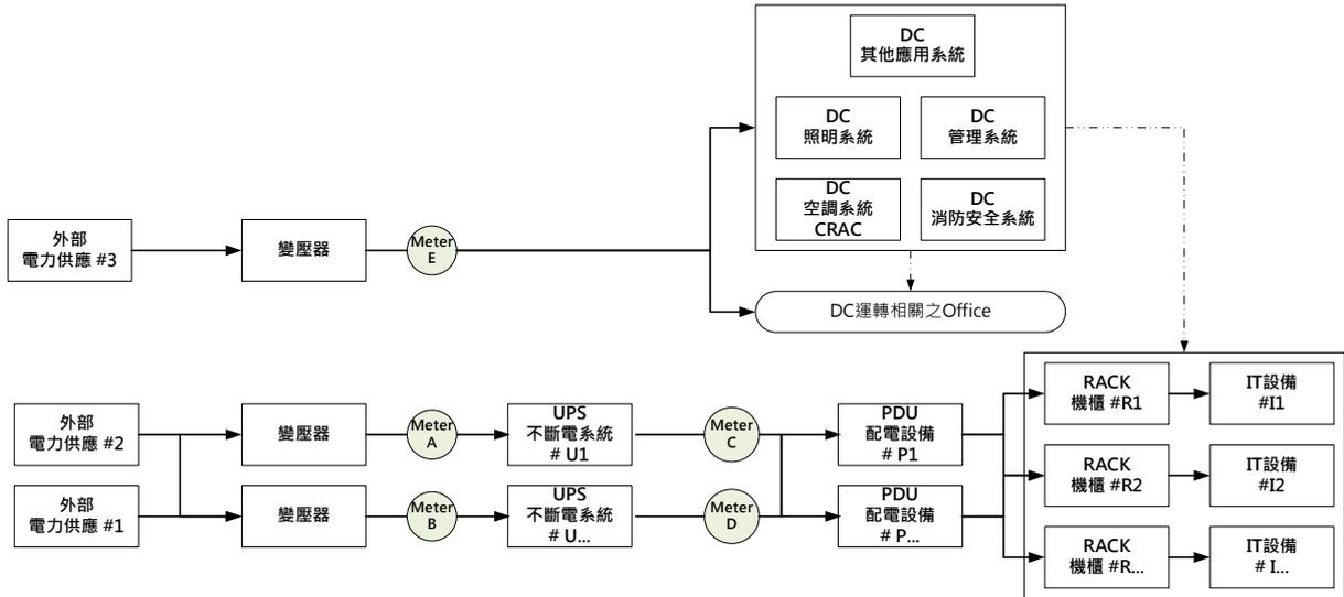
圖 16. 資料中心樣態 8 架構圖與PUE<sub>TaiSEIA</sub>量測位置
