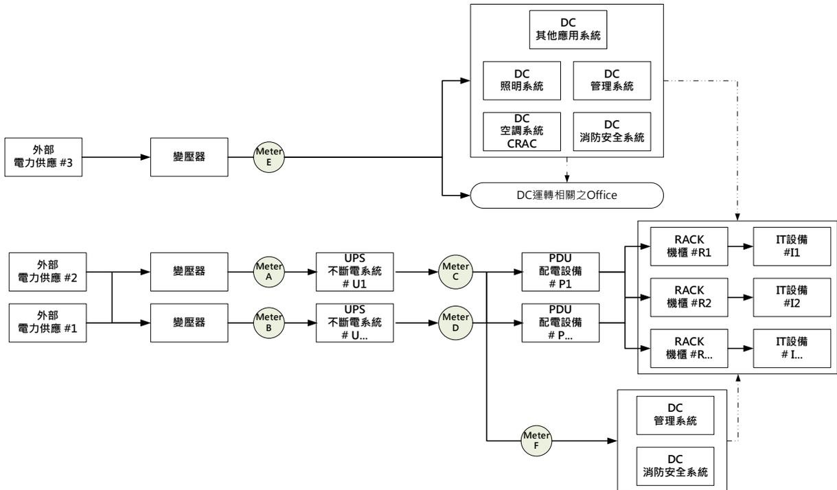
圖 17. 資料中心樣態 9 架構圖與PUE<sub>TaiSEIA</sub>量測位置
