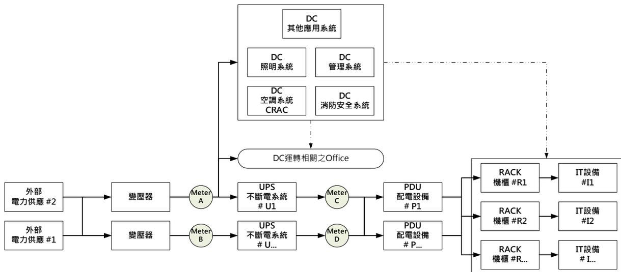
圖 9. 資料中心樣態 1 架構圖與 PUE<sub>TaiSEIA</sub> 量測位置
